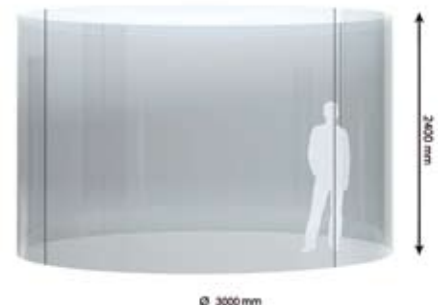
Gebogenes vorgespanntes Glas (c) Min. Radius
