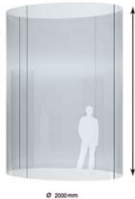
Gebogenes vorgespanntes Glas (b) Min. Radius
